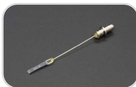
AWG CWDM光ハーネス (1→4分波 4CH Demux仕様)
