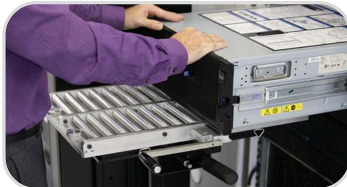
ServerLIFT本体のプラットフォームは左右に稼働しますが、本オプションは更に容易に稼働させる機能を有しています。
