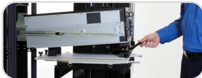
ドロップイン式のサーバーをマウント/アンマウントする際に使用します。ServerLIFTに搭載したサーバーを斜めにして、引き出されたレールへサーバーをマウント出来る機能があります。
