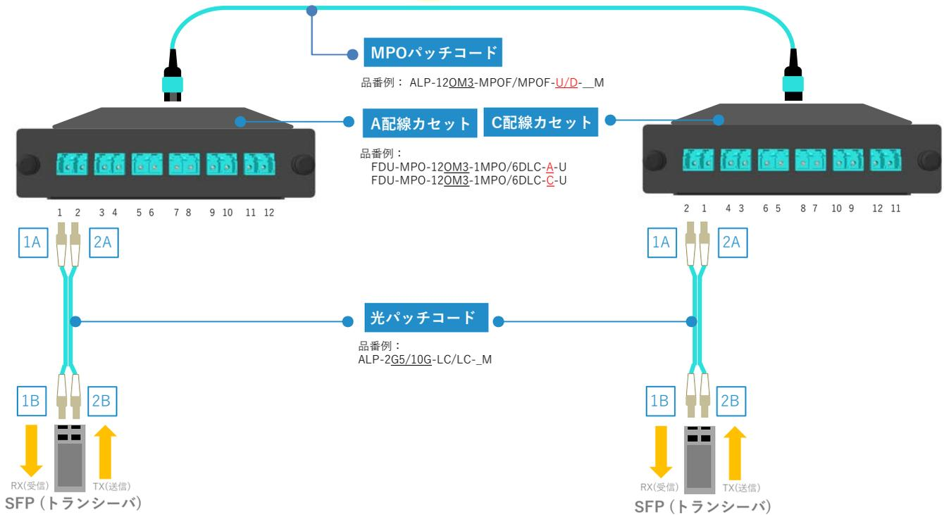
カセット間ケーブルがメソッドAの場合、**B配線カセット**+**BX配線カセット**の組み合わせでも、上記の配線構成を再現することが可能です。
