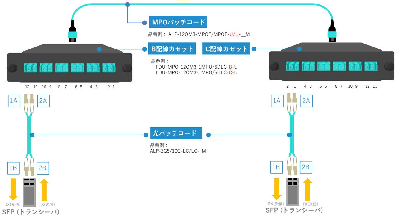
カセット間ケーブルがメソッドBの場合、**A配線カセット**+**BX配線カセット**の組み合わせでも、上記の配線構成を再現することが可能です。
